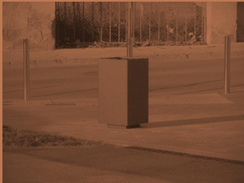
Il manico del sacco e il sistema di estrazione facilitano la manutenzione e la pulizia delle aree urbane. Realizzato in lamiera lavorata, piegata e saldata, è disponibile in acciaio zincato con primer antiruggine e verniciatura a polvere o in acciaio corten granigliato. È autoportante e facile da installare sulla pavimentazione grazie a quattro barre di fissaggio.
